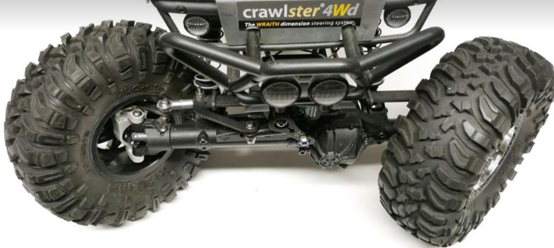
Bei korrekter Montage werden – bei Vollausschlag rechts/links und senderseitiger Wegeeinstellung 100% – die physischen Wege der Anlenkung kurz vor den gegebenen Begrenzungen enden, d.h. das jeweils kurveninnere Rad wenige mm vor den vorderen/unteren Links, das kurvenäußere Rad am Anschlag der vorderen Lenkarme. Wegeeinstellung ggf. geringfügig anpassen.
