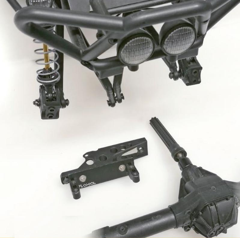
**Demontage der kompletten Vorderachse,** Räder, Lenk- und Anlenkgestänge, Dämpferaufnahmen, Servo, Servo-Halterung, Knuckles, C-hubs, obere und untere Links...
