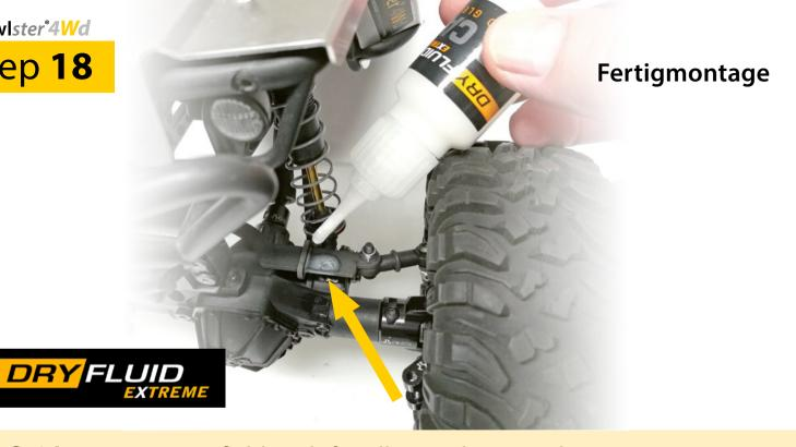
Dryfluid Extreme empfiehlt sich für alle crawlster®LenkSysteme – der Hochleistungs-Gleitstoff für alle beweglich gelagerten konstruktiven Elemente wie Wellen, Gelenke etc.
