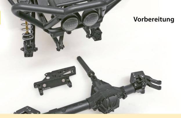
**Demontage der kompletten Vorderachse,** Räder, Lenk- und Anlenkgestänge, Dämpferaufnahmen, Servo, Servo-Halterung, Knuckles, C-hubs, obere und untere Links...
