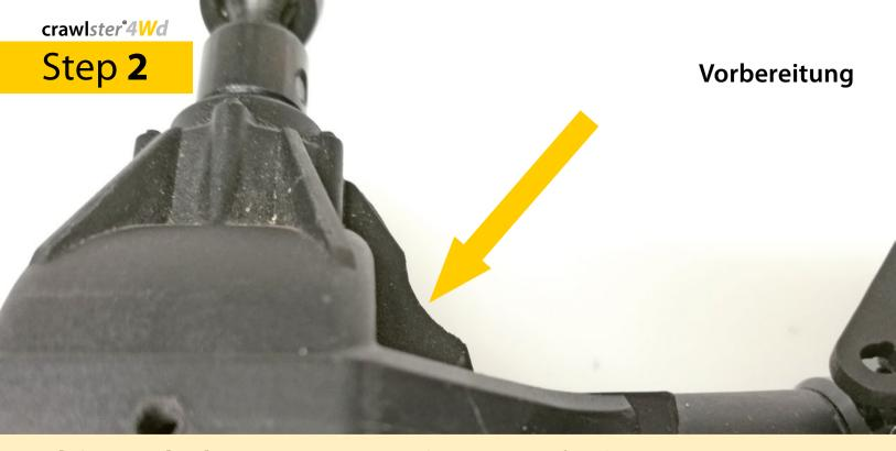
**Kleine Auskerbung** von ca. 4 mm (v. vorne "rechts") am mittleren Steg des Differential-Gehäuses anbringen
