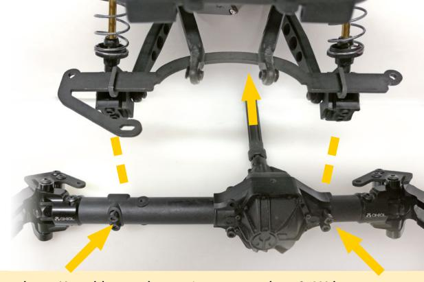
**Achse** mit vertauschten Knuckles und montierten crawlster®4Wd LenkWinkeln an die mit dem LenkSystem vorbereiteten Stoßdämpferaufnahmen **montieren**; *Zusammenstecken der Antriebswelle nicht vergessen*!
