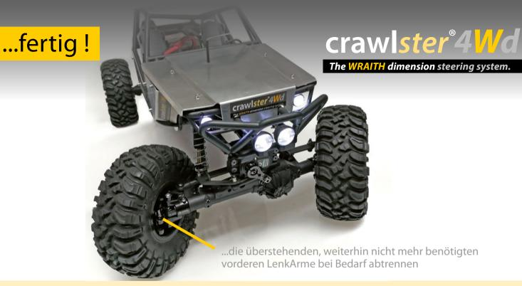
Bei korrekter Montage werden – bei Vollausschlag rechts/links und senderseitiger Wegeeinstellung 100% – die physischen Wege der Anlenkung kurz vor den gegebenen Begrenzungen enden, d.h. das jeweils kurven<u>innere</u> Rad wenige mm vor den vorderen/unteren Links, das kurven<u>äußere</u> Rad am Anschlag der vorderen Lenkarme. Wegeeinstellung ggf. geringfügig anpassen.
